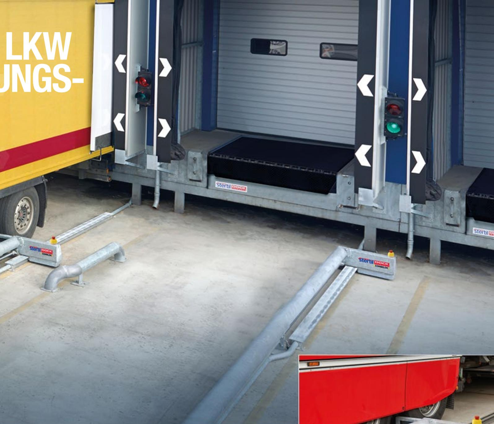
darauf ausgelegt, das Unfallrisiko zu reduzieren. Der Radkiel ist mit einem manuellen Notauschalter versehen, mit dem die Aktivierung des COMBILOKS sofort gestoppt wird. Außerdem sorgt eine externe rot/grüne Signalleuchte für eine eindeutige Kommunikation mit dem Fahrer. Der Fahrer erhält erst dann grünes Licht zur Abfahrt, wenn der Radkiel vollständig eingezogen wurde.
