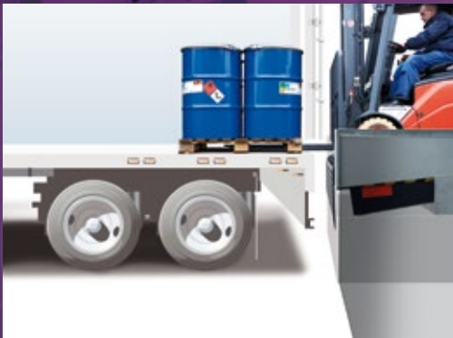
Positionierung unter Rampenniveau
