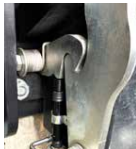
Automatische Verriegelung in vertikaler Position
