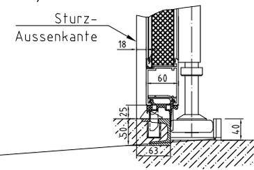
d) Schwellenlos Riegelanschlag RA
