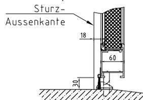
e) Flachstahlschwelle S10D
