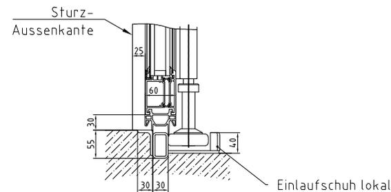
b) Flachstahlschwelle S20D
