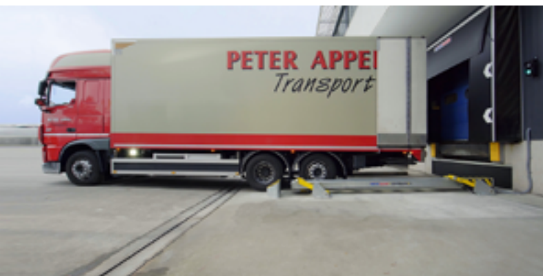
Große Raddurchmesser, doppelte Hinterachse und Seiten- und Unterfahrschutz.
