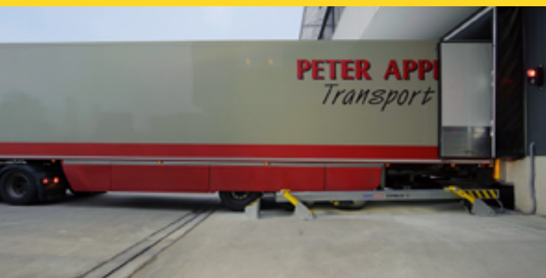
Anhänger mit Seitenverkleidung und geringer Bodenfreiheit.
