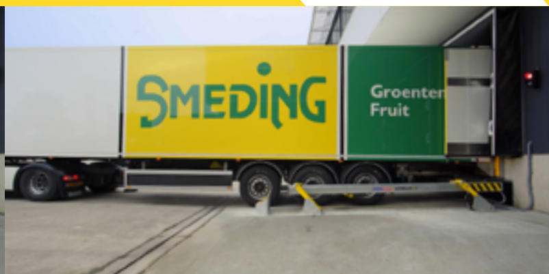
Anhänger mit mehreren Achsen und Hinterlenkachsen.
